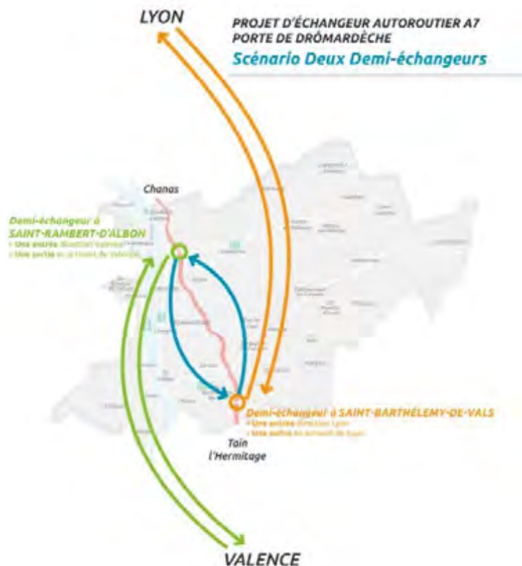
Figure 63 - Demi-échangeur (source : VINCI Autoroutes)
