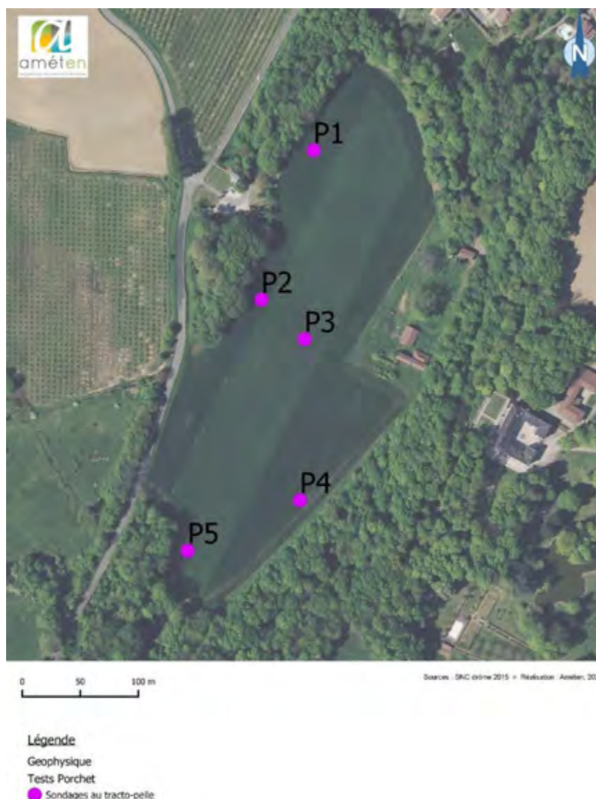
Figure 9 – Localisation des tests de perméabilité (source : AMETEN /Gone Environnement)
