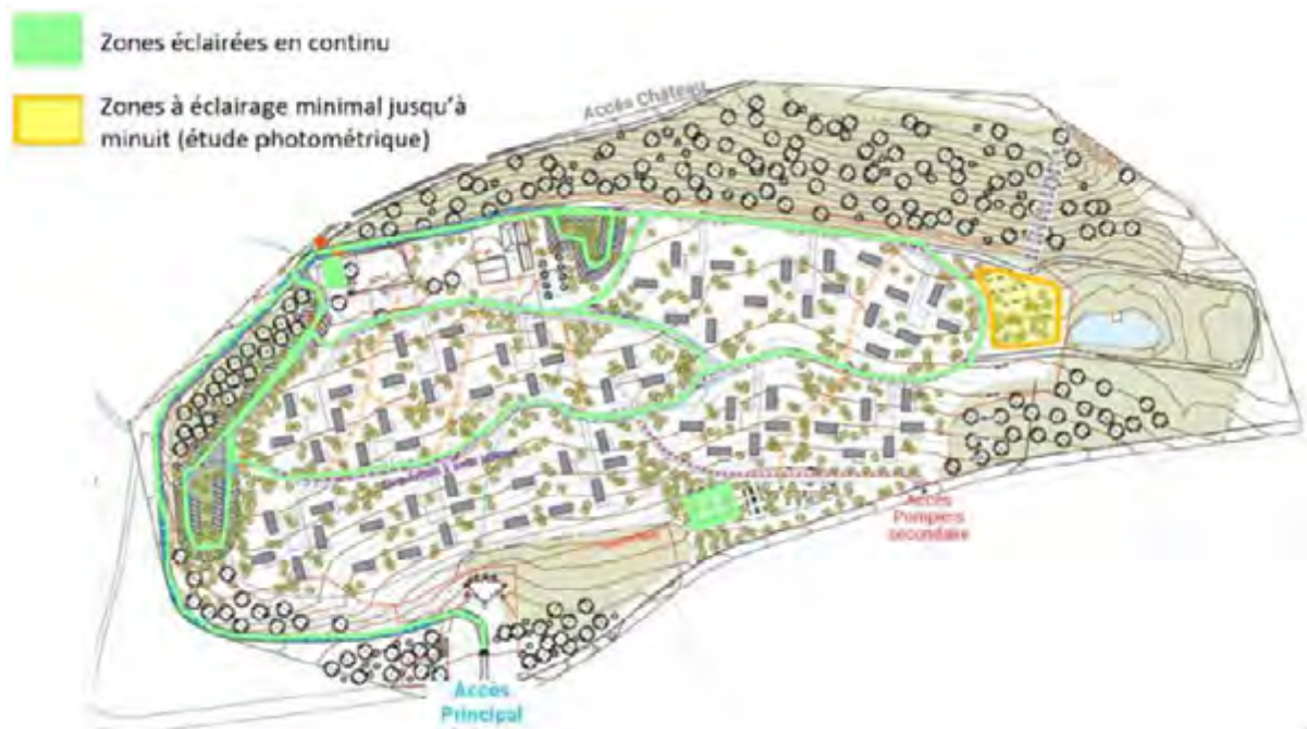
Figure 84 - Emissions lumineuses du projet pendant sa phase d'exploitation (source : Gone Environnement)
