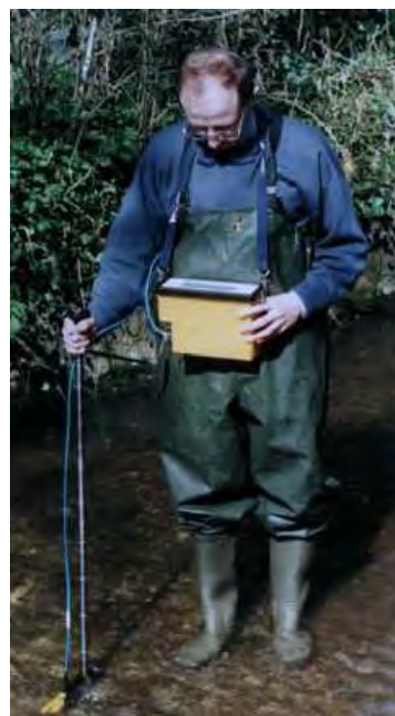
Illustration de la réalisation d'une mesure au vélocimètre (source : fiche vélocimètre Hydreka)
