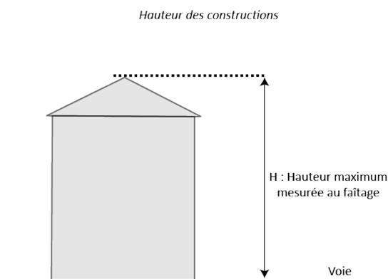
**Illustration de calcul de la hauteur mesurée au faîtage**
